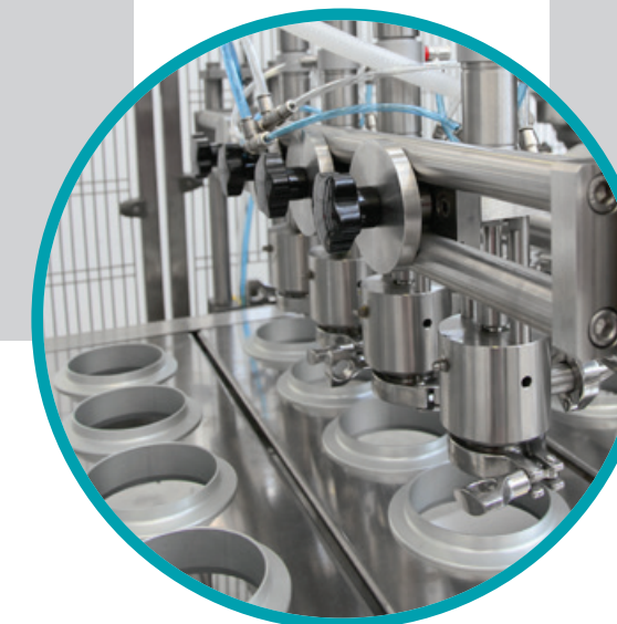
Stazione topping / Topping station
