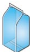
confezione a fondo quadro con 4 saldature verticali block bottom bag with 4 vertical seals
